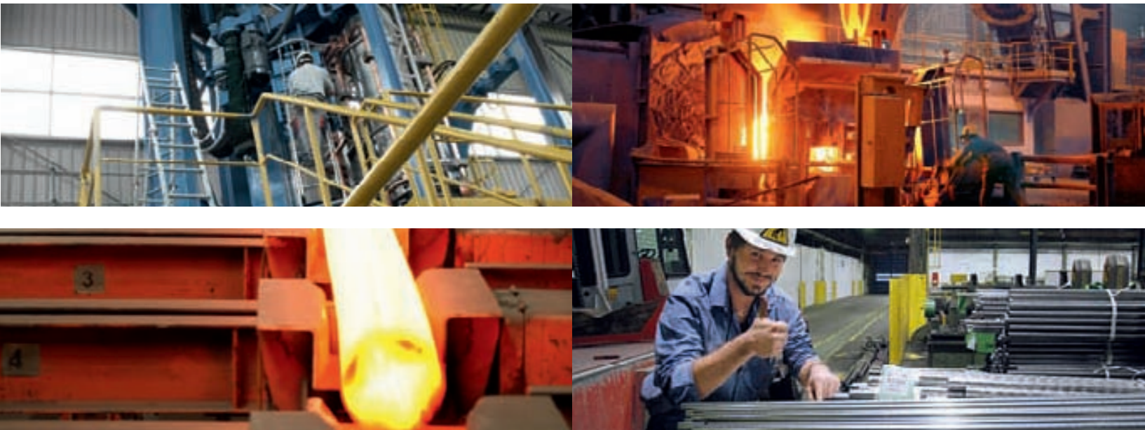
Von oben links nach unten rechts: Umschmelzung von Elektroschlacke | Verfahren zum Einblasen von Argon und Sauerstoff in das Flüssigmetall zur Entfernung von Kohlenstoff | Warmwalzwerk | Lagerbereich
